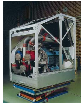
Wersja zasilana elektrycznie z wymiennikiem ciepła i osuszacz powietrza (model dla Szwedzkich Sił Powietrznych)
